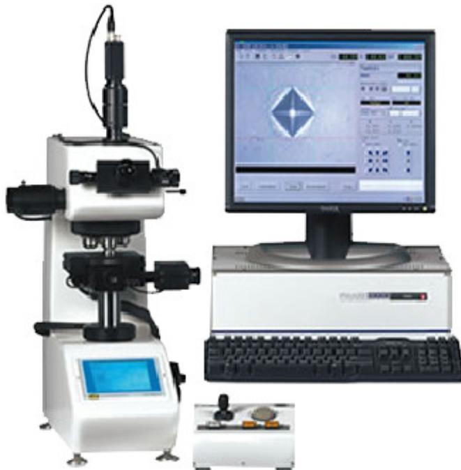
Este sistema de ensayos de dureza completamente automático, permite programar las posiciones en que se desea hacer los ensayos y el durómetro moverá la mesa de coordenadas a la posición, realizará el ensayo, visualizará la huella y la medirá de forma automática.
