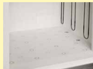
A partir del horno de alta temperatura HT 16/16 se incluye como característica estándar el suelo reforzado para aliviar la carga del aislamiento de fibra
