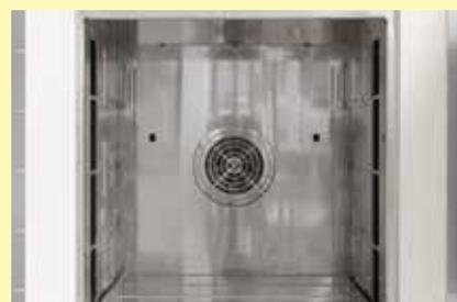
Interior fabricado con lámina de acero 1.4828
