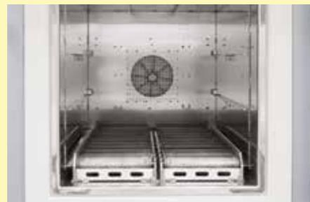
Rodillos en la cámara del horno
