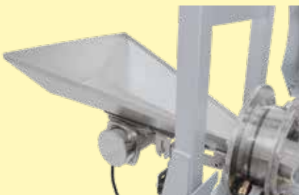
Canal vibratorio en el tubo giratorio para una conveniente alimentación del material
